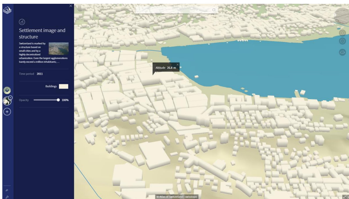
Obr. 2: Model Curychu v LoD 1. Zdroj: AoSo (2016)
