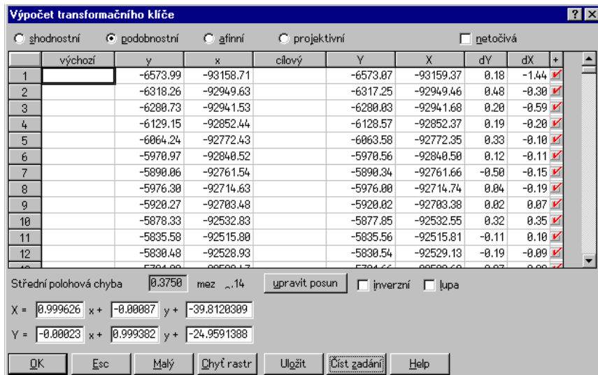
obr. 44 Ukázka dialogu Výpočet transformačního klíče s nastavením pro dotransformaci
