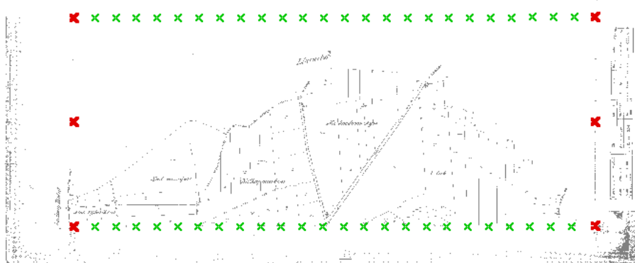
obr. 18 Ukázka mapového listu s rekonstruovanými body protilehlých sekcí mapového rámu
