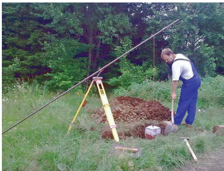
Přestabilizace TB během testovacího měření GNSS prováděného za účelem zpřesnění transformačních tabulek na území 18 TL
