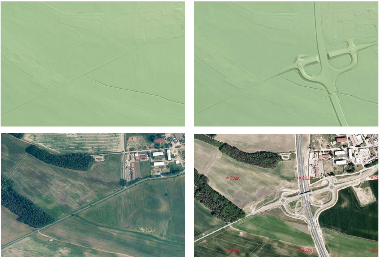
Obr. 5.3 Porovnání DMR 5G před (2010) a po aktualizaci (2022), doplněno daty z LMS v roce 2010 a 2022
