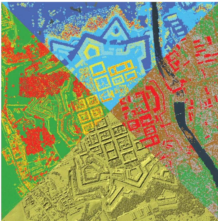
Obr. 5.4 Různé způsoby vizualizace mračka bodů (z LLS prostoru pevnosti Terezín), vlevo – sklonitost, nahoře – barevná hypsometrie, vpravo – klasifikace objektů, dole – stínovaný model
