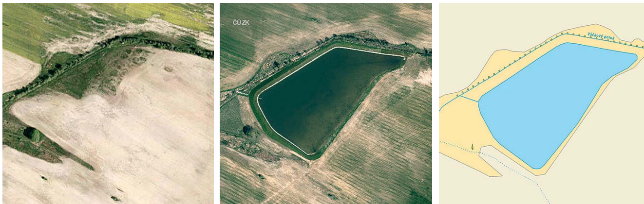
Obr. 4.1 Příklad provedené plošné aktualizace na podkladě změny identifikované v poslední edici ortofota (vlevo ortofoto z roku 2021, uprostřed ortofoto z roku 2023, vpravo aktuální stav v ZABAGED®)
