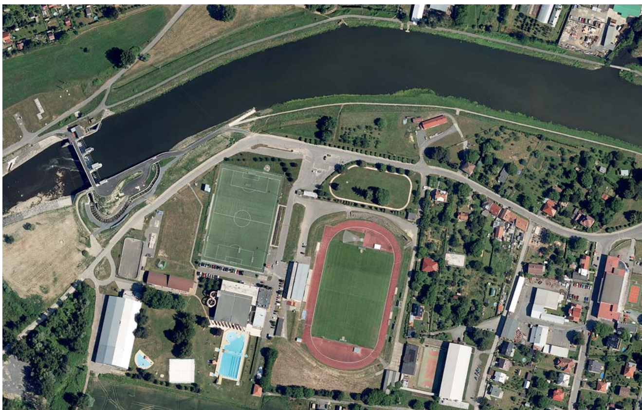
Obr. 6.5 Ukázka ortofota ČR s rozlišením 12,5 cm na zemi (Hranice, 2024)
