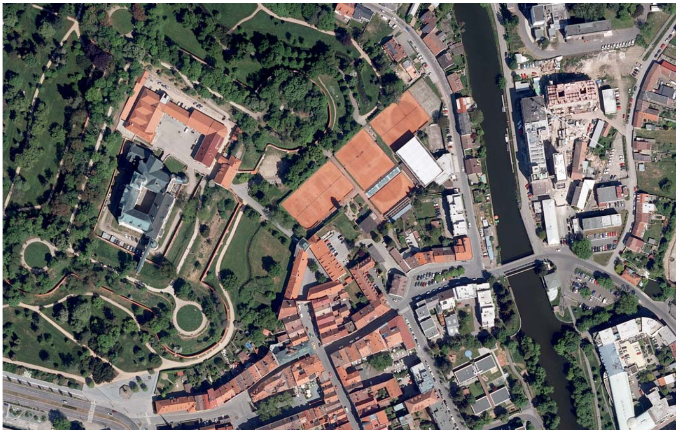
Obr. 6.4 Ukázka ortofota ČR s rozlišením 12,5 cm na zemi (Pardubice, 2024)
