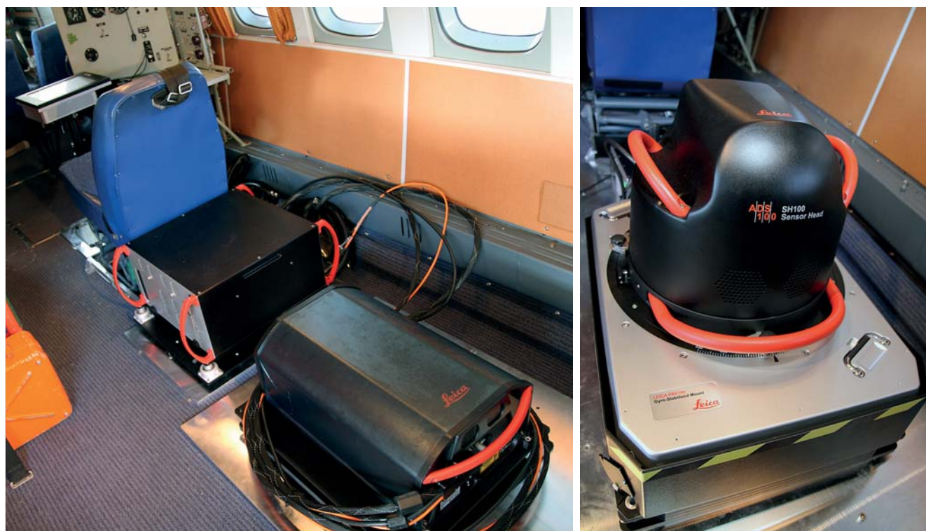
Obr. 6.12 Instalace ALS80 (vlevo) a instalace ADS100 (vpravo)
